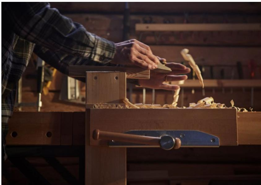
Sjöbergs Kvadrat ist eine perfekte Hobelbank für den kleineren Holzbearbeitungsraum. Für eine flexiblere Klemmung ist die Oberseite mit einer doppelten Lochreihe für die runden Bankhaken ausgestattet. Darüber hinaus ist der Schraubstock stabil, sicher und verstellbar.
